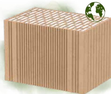
Die optimierte Lochgeometrie sorgt für hervorragenden Schall- und Wärmeschutz in Kombination. Die neue, innovative Mikroverzahnung mit vielen kleinen Luftkammern vermindert den Wärmeverlust über die Stoßfuge. Das Ergebnis: eine massive Ziegelwand mit U-Werten bis 0,16 W/(m²K)! Der Poroton-S8-P ist somit der optimale Ziegel für den Objektbau, geeignet auch für KfW-Effizienzhäuser 40 (KFN).
